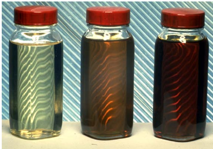
Resim 2. Aynı yağın kullanım sonrası gösterdiği renk değişikliği
