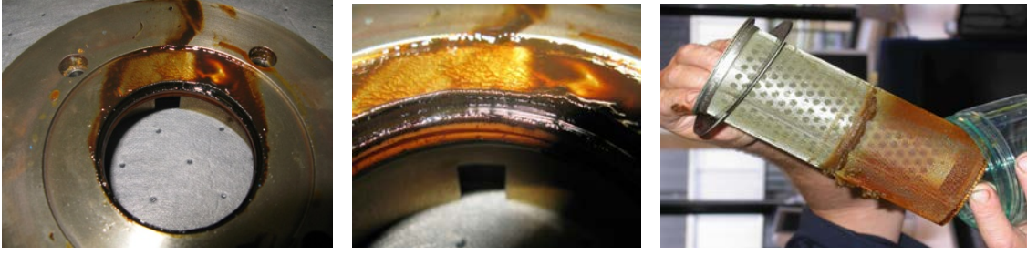
Resim 3. Parlak yüzeylere yapışan verniklenme örnekleri ve filtrede oluşan verniklenme
