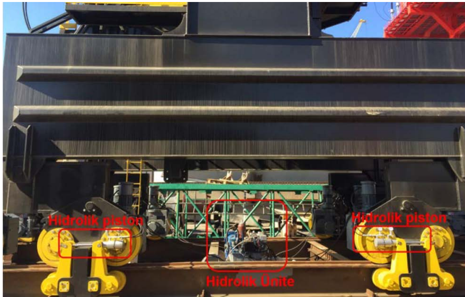
Şekil 9. Servis vinçlerinde servo performanslı oransal valf ile kuvvet kontrolü uygulaması
