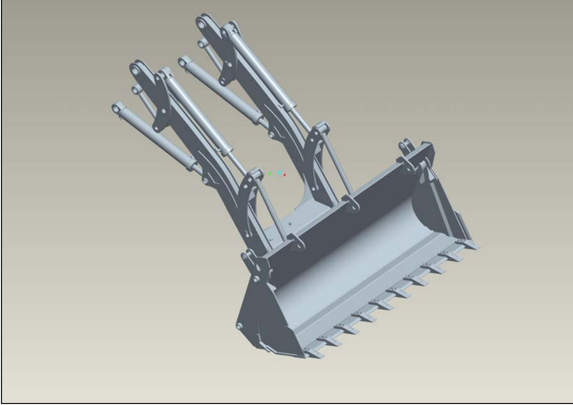
Şekil 2.6. HMK 102B Yükleyici Mekanizması 3 Boyutlu Çizimi
