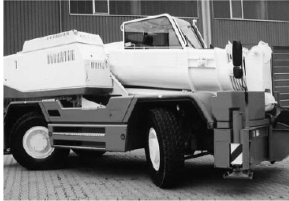
Şekil 7. Bir uygulama örneği: hidrostatik tahrikli ve elektronik patinaj önleme sistemli (ASR), her türlü arazide kullanılabilen vinç
