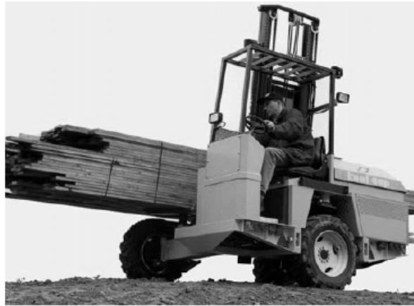
Şekil 4. Bir uygulama örneği: kayma önleyici çift devre tipi hidrostatik tahrik sistemine sahip taşıma/istifleme aracı
