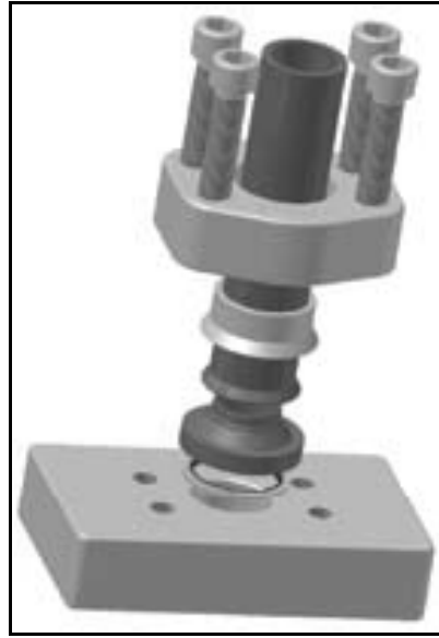
Şekil 3. Flanş – Port küçük boru boyutları için bağlantı
