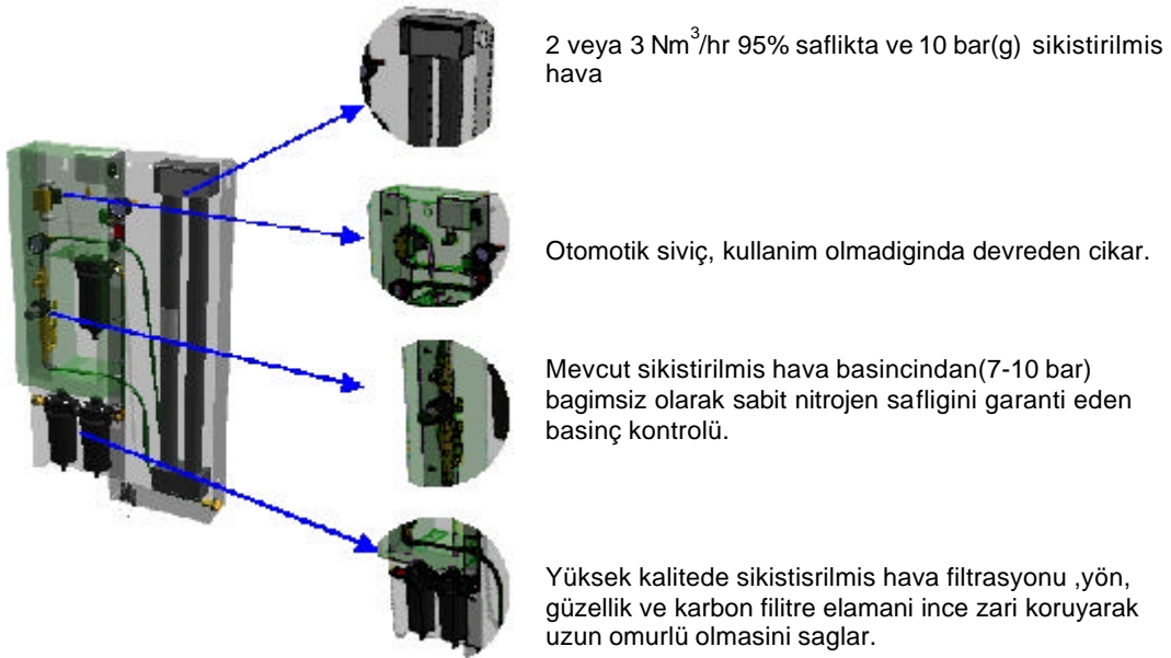
Sekil 4. Havadan azot elde edilmesini sağlayan cihazın çalışma safhaları
