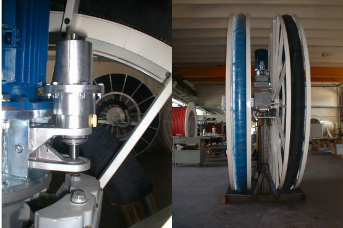
Resim 5. Yay uyarili kaliper fren
