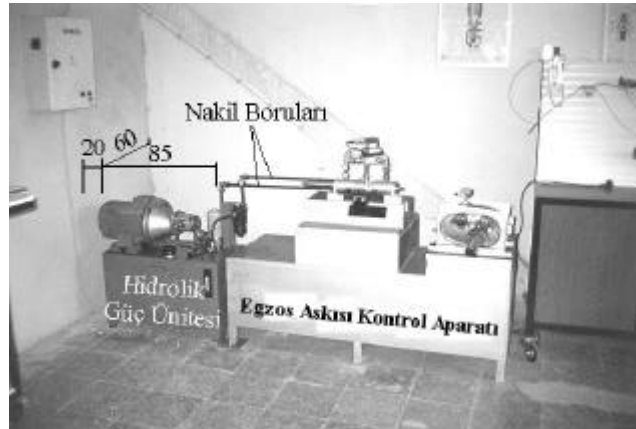
Sekil 2. Egzoz Askısı Bağı Kontrol Aparatı [1]
